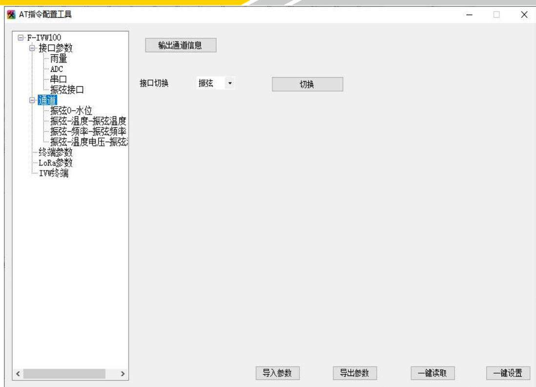
若选择振弦传感器，则需进行振弦传感器的相应参数配置，配置完成点击“一键设置”保存相关参数，配置完成后重启设备。
