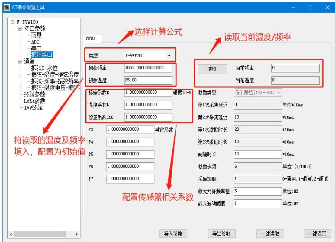
若选择 RS485 接口，则通道-通信参数中相关参数需配置，配置完成后重启。
